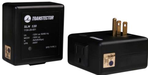
El protector contra sobretensiones SLN 120 AC es un dispositivo SASD (diodo supresor de avalancha de silicio) de estado sólido diseñado para proteger los equipos y sistemas electrónicos de sobretensiones transitorias en servicios monofásicos de 120 V CA. El SLN 120 ofrece protección bidireccional bipolar continua, con la capacidad de restablecerse automáticamente después de cada función de supresión sin degradación de las capacidades de protección.
