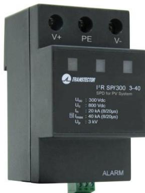
Dispositivo de protección contra sobretensiones de CC montado en carril DIN, diseñado con tecnología MOV para cumplir los requisitos de Tipo 2. Equipado con indicación visual del estado de la supresión y contactos secos "Forma C" aislados eléctricamente para permitir la supervisión remota.
